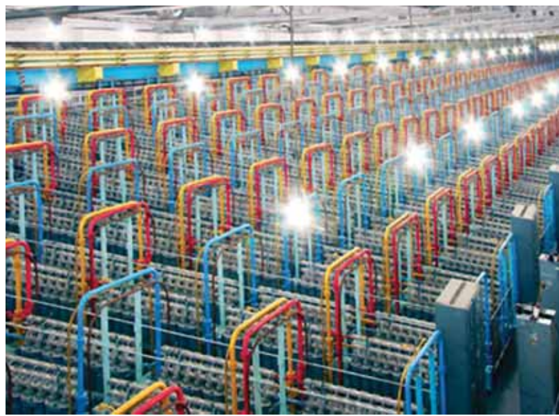
Секции газовых центрифуг, разделяющих изотопы урана
